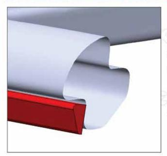
MAKE SURE GASKET IS ORIENTED AS SHOWN WITH THE LARGE PART OF THE WEATHERSTRIP FACING AWAY FROM THE DOOR.
